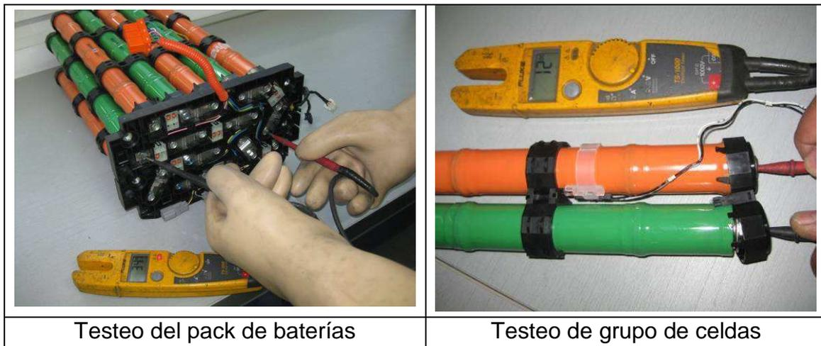
**Figura 10.** Ejemplo de testeo del batería de NiMH (Fuente: INDUMETAL)
