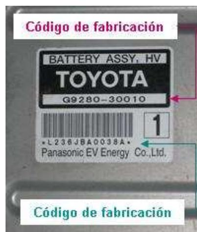
**Figura 8.** Ejemplo de códigos de batería de Panasonic EV Energy para Toyota (Fuente: INDUMETAL)
