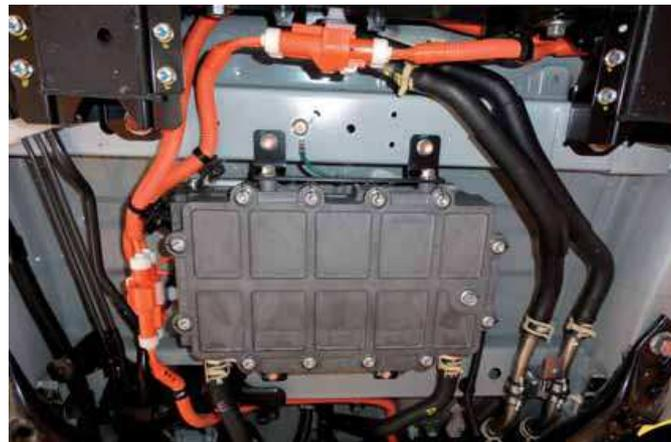
**Figura 7.** Aislamiento y protección del cableado de alta tensión, de color naranja normalizado (*Fuente: CESVIMAP*)
